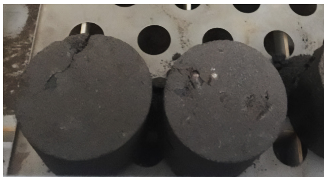
Рис. 3. Хранение образцов в камере нормального твердения
