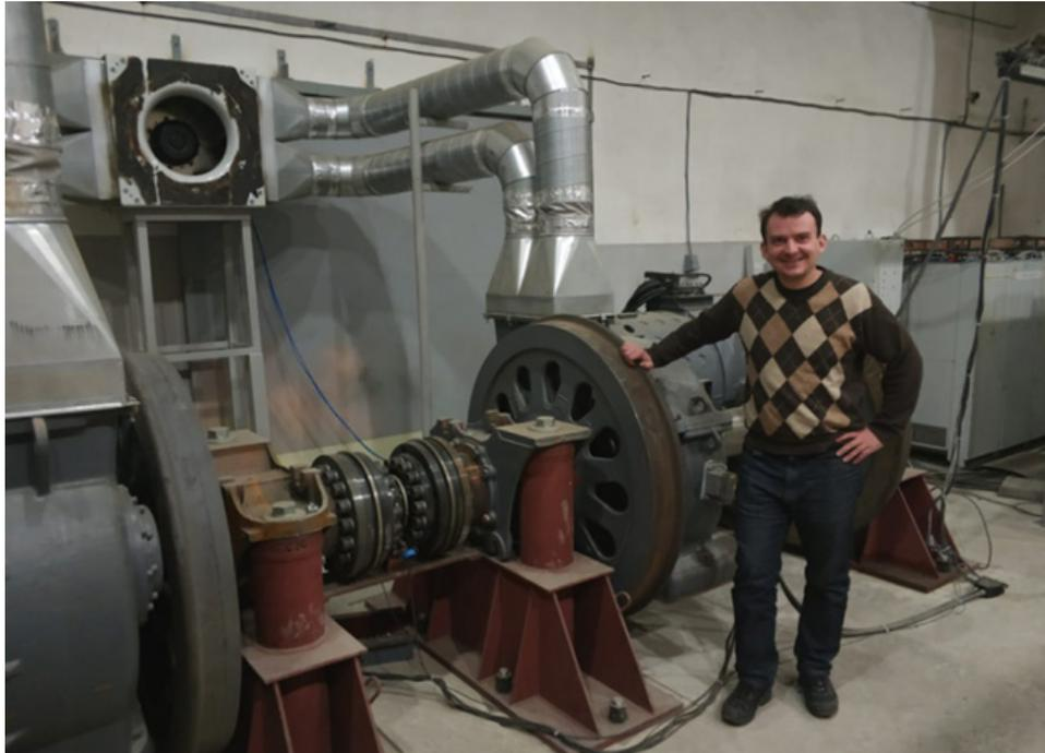
Рис. 1. Полноразмерный стенд для испытаний тяговой системы электровоза (общий вид)
