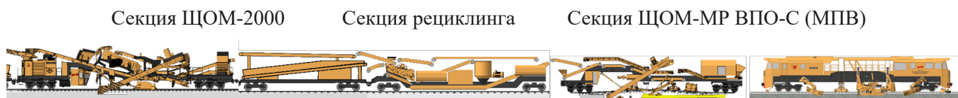
Рис. 2. Комплекс для устройства подбалластного защитного слоя
