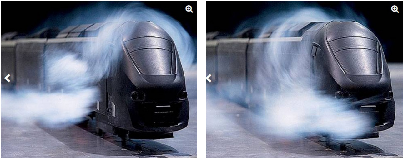
Рис. 2. Масштабная модель 1:15 TGV Duplex в рабочей камере аэродинамической трубы
