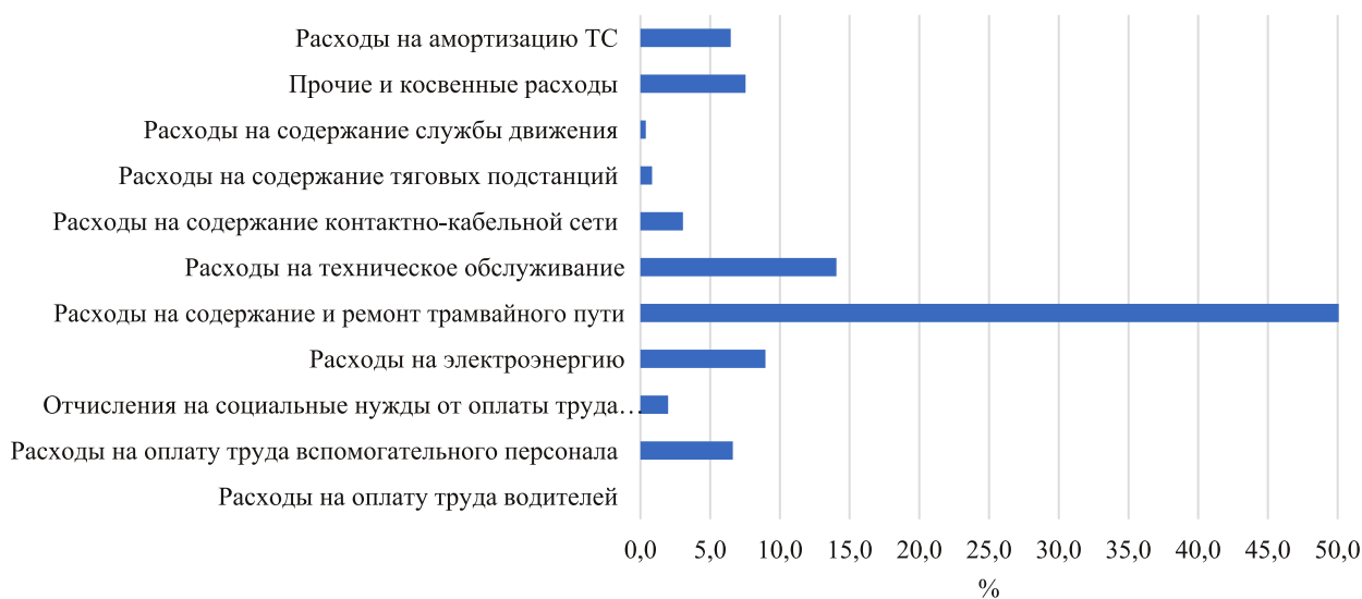
Рис. 8. Структура эксплуатационных затрат для Сценария 3 (работают 2 трамвая, отсутствует статья затрат на оплату труда водителей, но сохранена статья затрат на оплату труда вспомогательного персонала)
