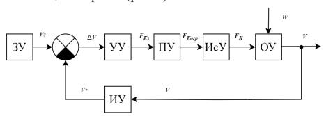
Рис. 2. Упрощенная функциональная схема САУ регулятора скорости
