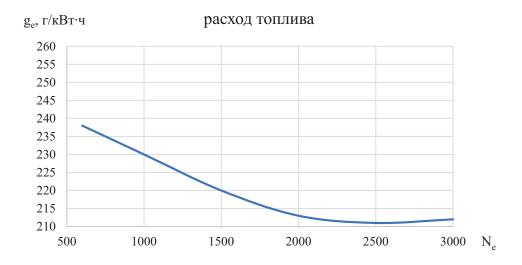
Рис. 8. Параметры расхода топлива дизеля Д49 16ЧН 26/26 в зависимости от мощности
