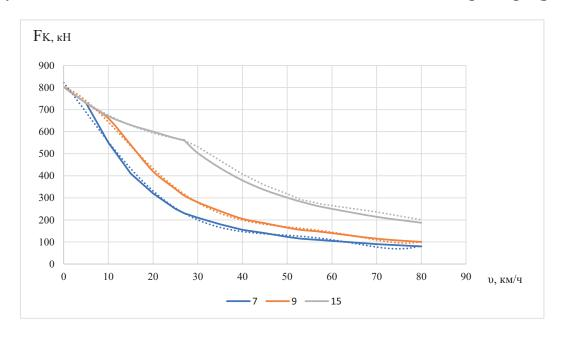
Рис. 3. Тяговые характеристики и аппроксимация их степенным полиномом на 7-й, 9-й, 15-й позициях контроллера
