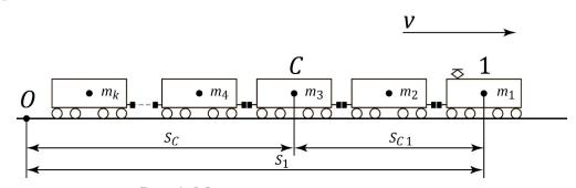
Рис. 1. Модель поезда для исследования
