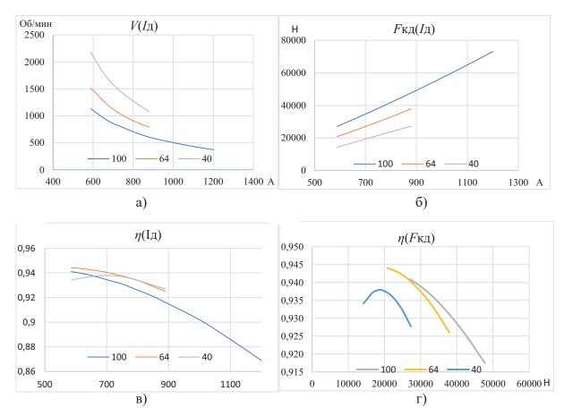
Рис. 6. Электромеханические характеристики тягового электродвигателя ЭД133[10]
