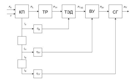
Рис. 5. Алгоритм нахождения расхода топлива
