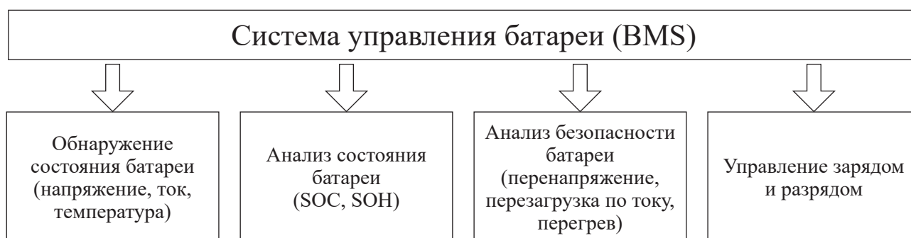
Рис. 1. Основные функции системы управления батареями
