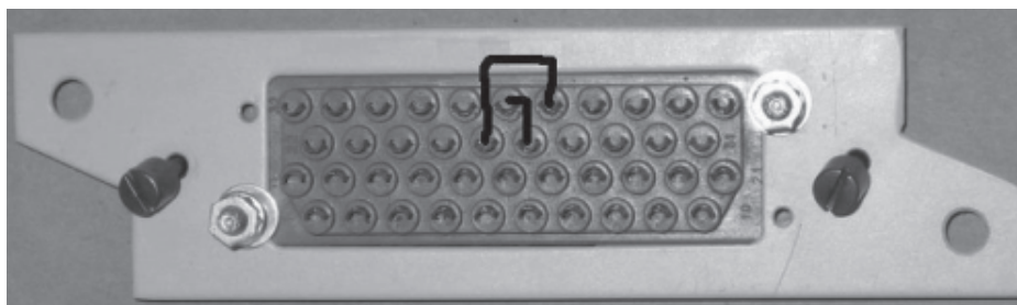
Рис. 4. Вид ответной части разъема с перемычками, подключающими внутренний согласующий резистор
