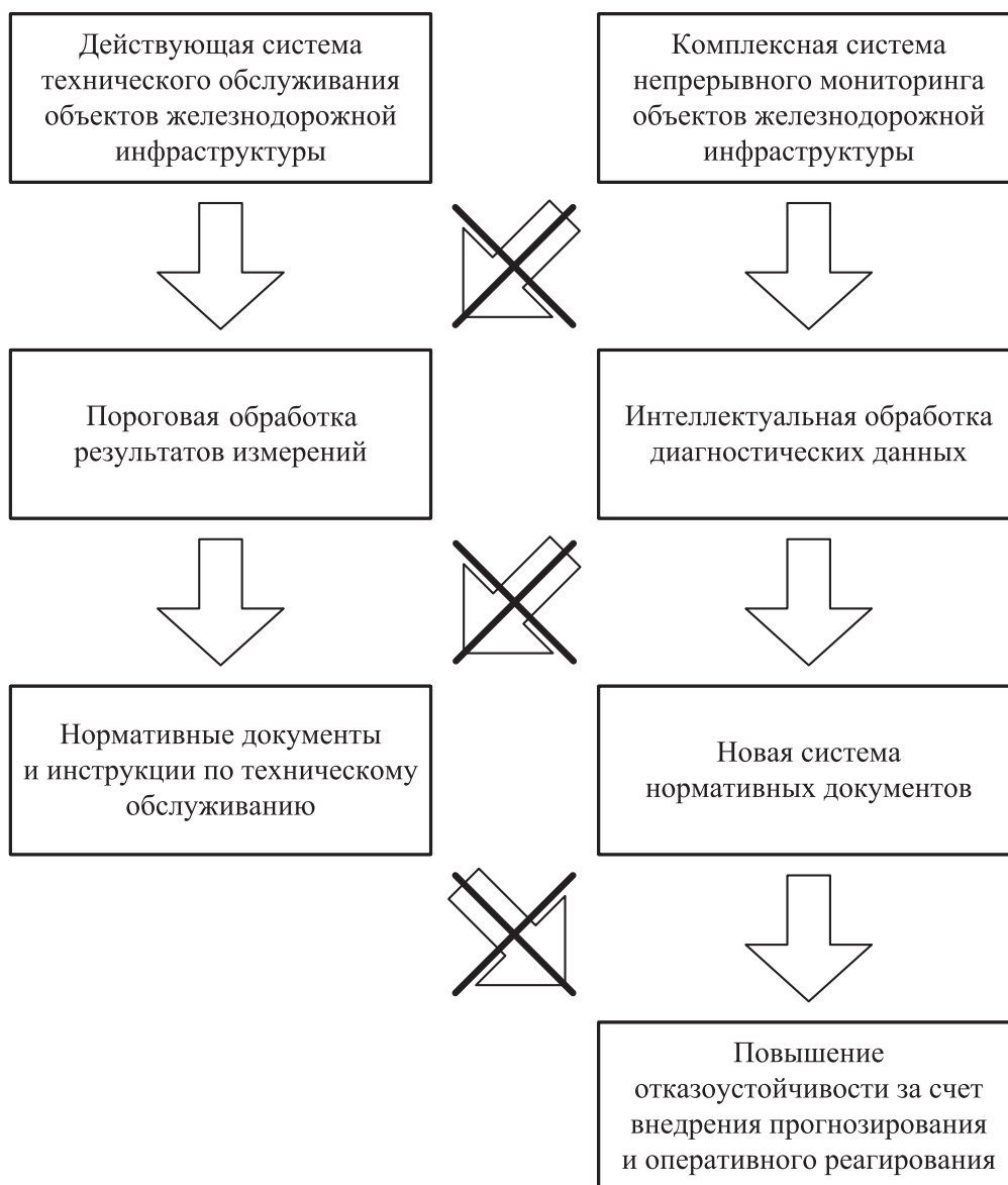
Рис. 5. Пути интеграции средств мониторинга в действующую систему технического обслуживания
