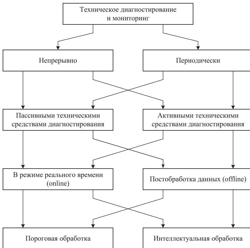
Рис. 4. Способы реализации процедур технического диагностирования и мониторинга
