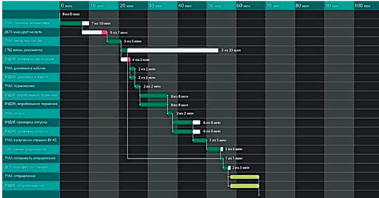
Рис. 2. Проверка реализации логического контроля операций по отправлению поезда на соответствие параметрам технологического процесса станции
