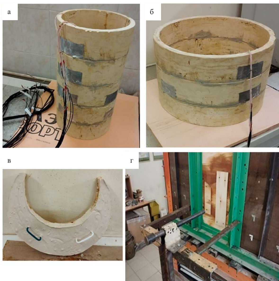
Рис. 4. Моделирование обделок перегонного и станционного тоннелей:
