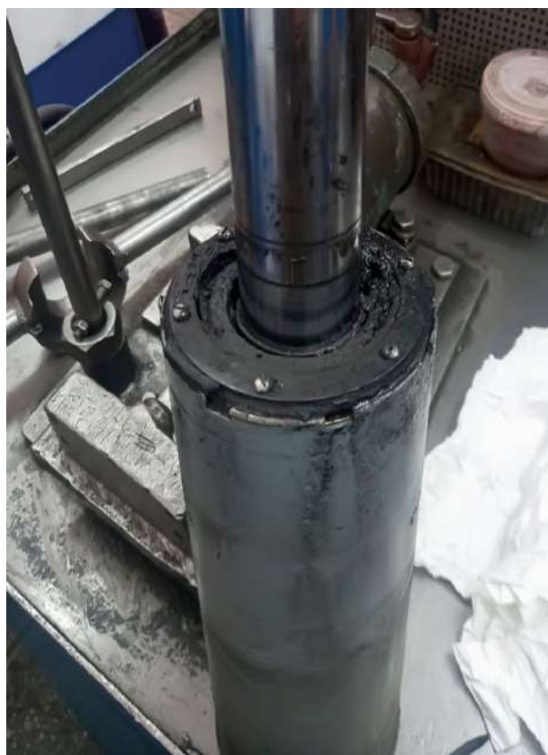
Рис. 2. Повреждение уплотнений штока гидрогасителя из-за подкожухового льдообразования (фото авторов)
