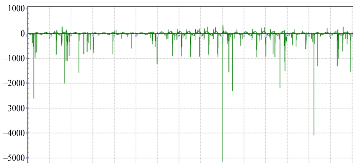
Рис. 5. Продольная сила крива на левом колесе с ползуном
