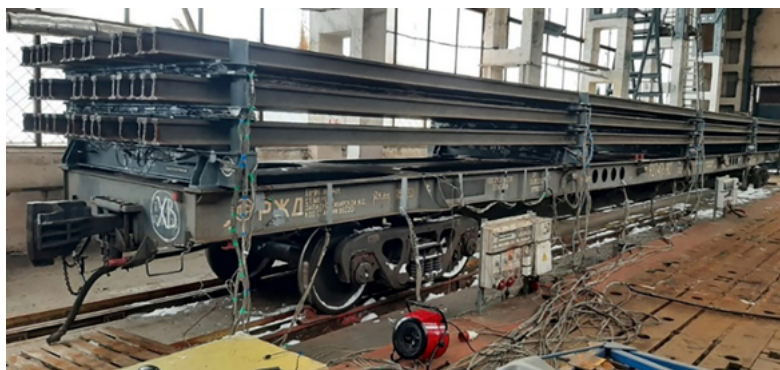
Рис. 8. Функциональные и статические испытания на прочность
