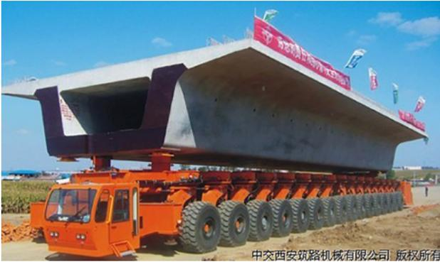
Рис. 3. 16-осный балочный транспортер YL900 [11]
