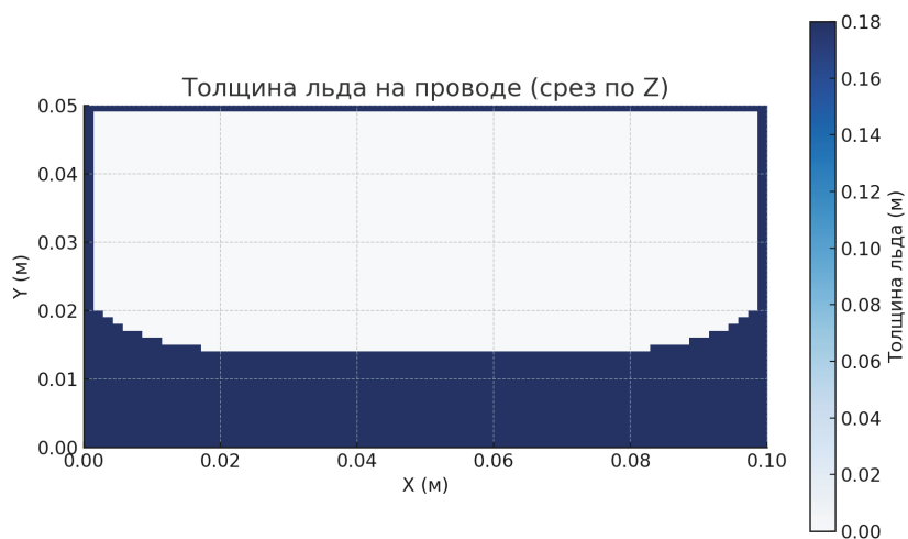
Рис. 4. Распределение толщины льда на проводе
