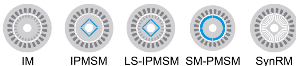
Рис. 1. Различные конфигурации роторов (слева направо): асинхронный, или индукционный, двигатель (IM); синхронный двигатель с внутренним постоянным магнитом (IPMSM); синхронные двигатели с внутренним постоянным магнитом и обмоткой ротора (IPMSM с прямым пуском); синхронный двигатель с поверхностным постоянным магнитом (SM-PMSM); синхронный реактивный двигатель (SynRM)
