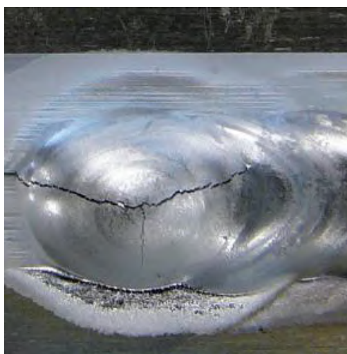
Рис. 1. Растрескивание сварочного шва после сварки алюминиевого сплава [7]
