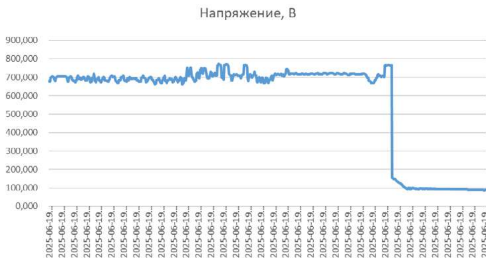
Рис. 11. График напряжения в момент отключения диспетчером фидера «Решетникова»
