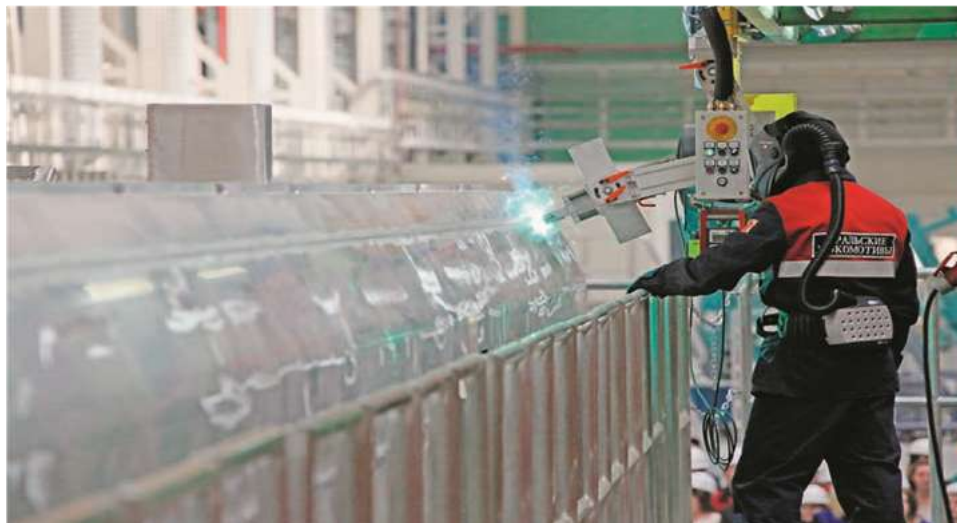
Рис. 2. Роботизированная сварка алюминиевого корпуса в среде защитного газа на предприятии «Уральские локомотивы» [8]
