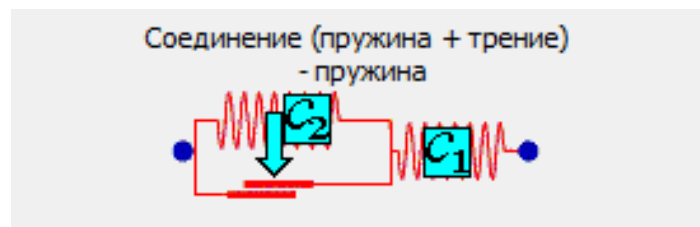
Рис. 4. Схема соединения элементов рессорного подвешивания в программной среде «Универсальный механизм»
