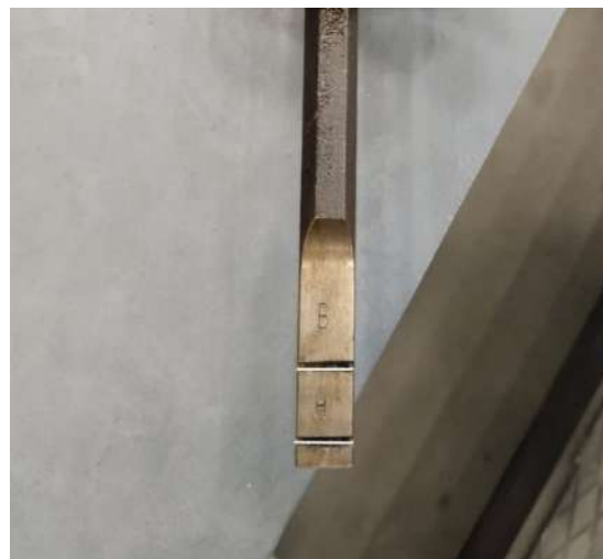
Рис. 7. Маслоуказательное окно и масломерная линейка модифицированного кожуха зубчатой передачи (фото Д. А. Колотай)
