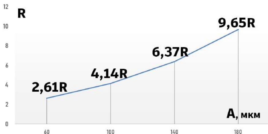
Рис. 3. Зависимость амплитуды колебаний на уровне основной площадки земляного полотна A (мкм) от величины R , учитывающей вертикальное перемещение точки (площадки) контакта колеса и рельса
