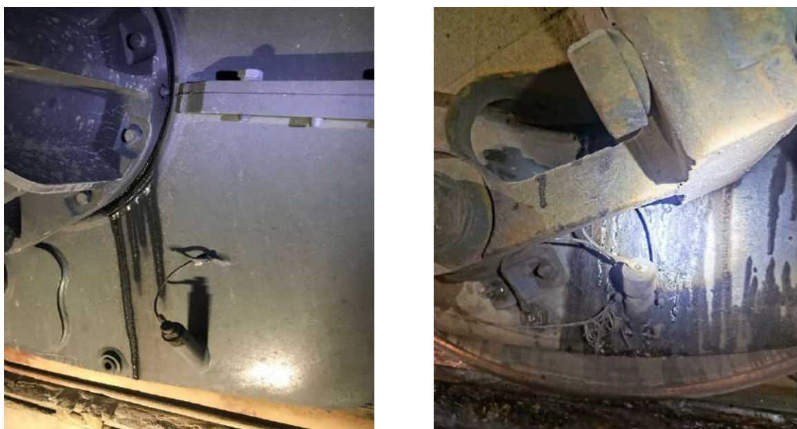
Рис. 5. Состояние существующей конструкции КЗП после 30 тыс. км пробега локомотива (фото Д. А. Колотай)
