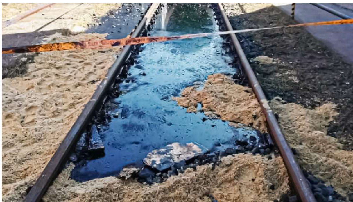
Рис. 4. Разлив смазки на путях отстоя локомотива с негерметичным КЗП (фото Д. А. Колотай)
