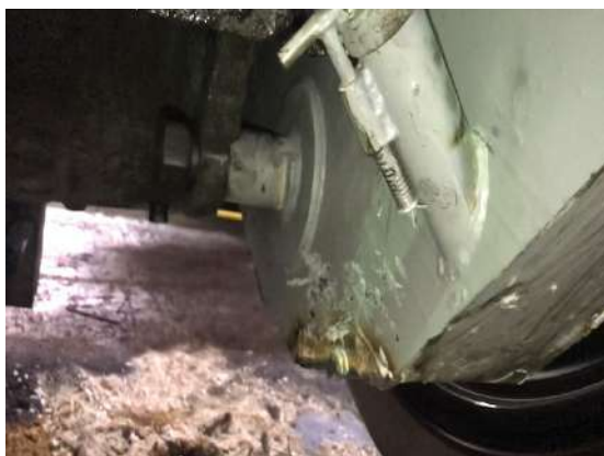
Рис. 8. Эксплуатация усовершенствованной конструкции кожуха зубчатой передачи. Пробег локомотивов — более 300 тыс. км (фото Д. А. Колотай)
