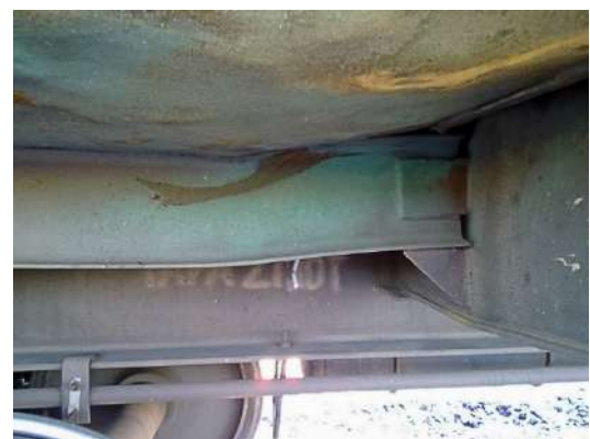
1 — хребтовая балка; 2 — поддерживающая балка; 3 — настил пола; 4 — нижняя обвязка
