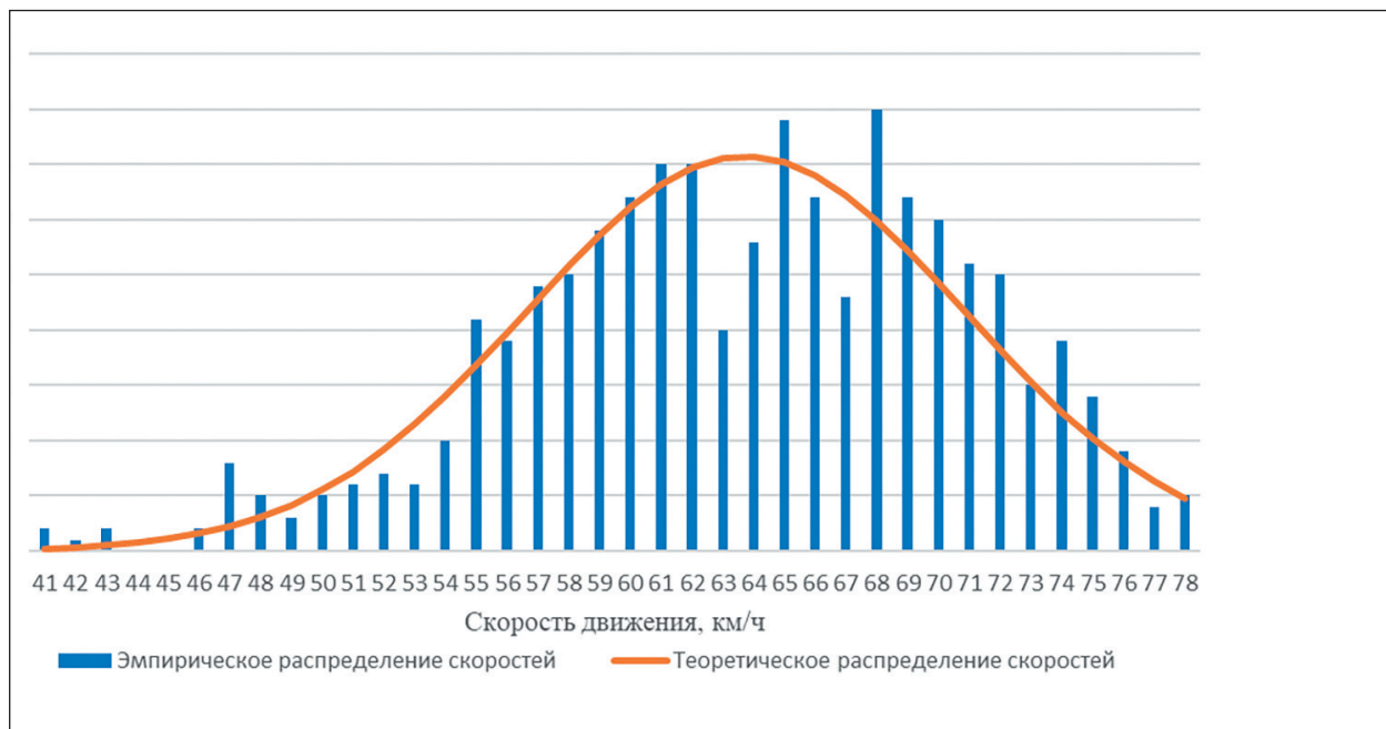
Рис. 1. Сравнение фактических данных с теоретическим законом распределения для тяжелых поездов
