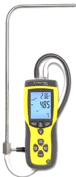
Рис. 2. Трубка Пито напорная цилиндрическая PFM 2
