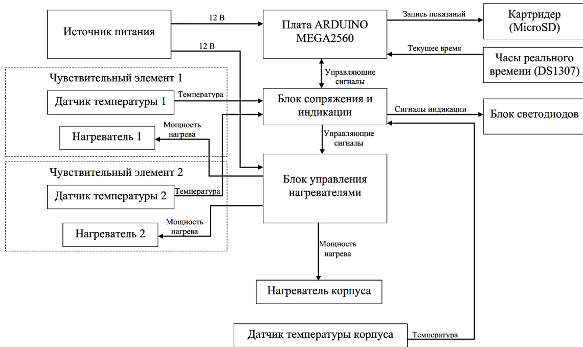
Рис. 1. Структурная схема датчика обледенения и контроллера
