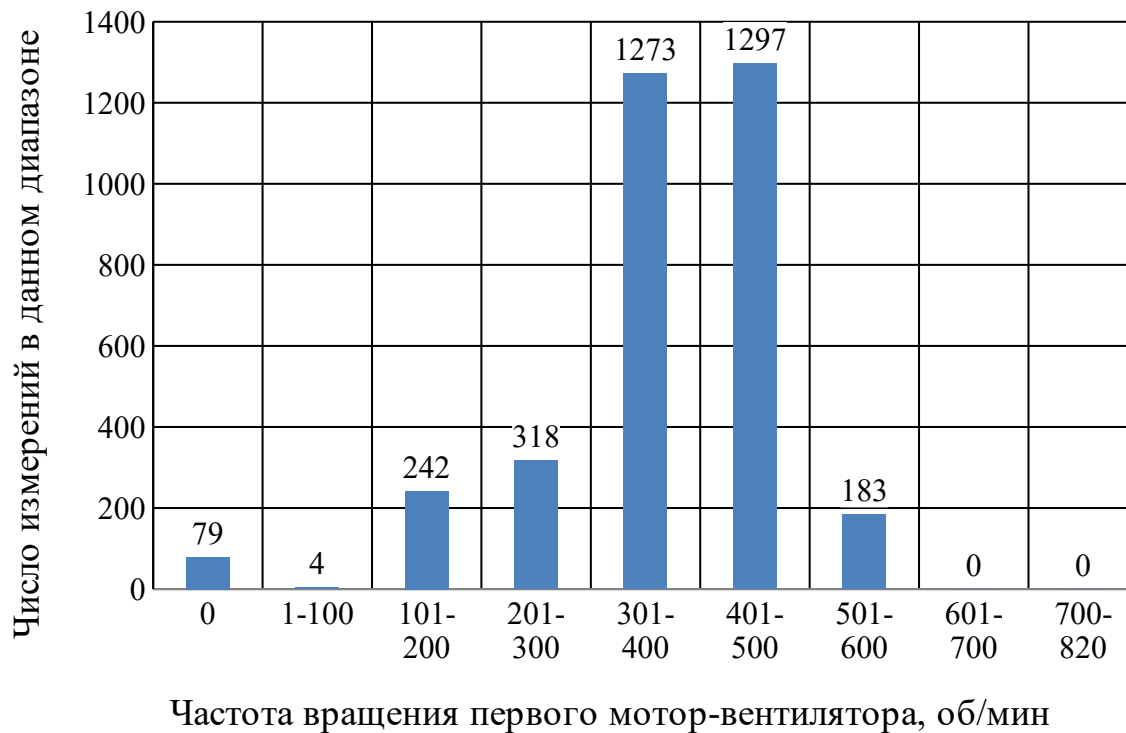
Рис. 4. Группированный статистический ряд частоты вращения первого мотор-вентилятора тепловоза ТЭП70БС № 176 на 13-й позиции контроллера
