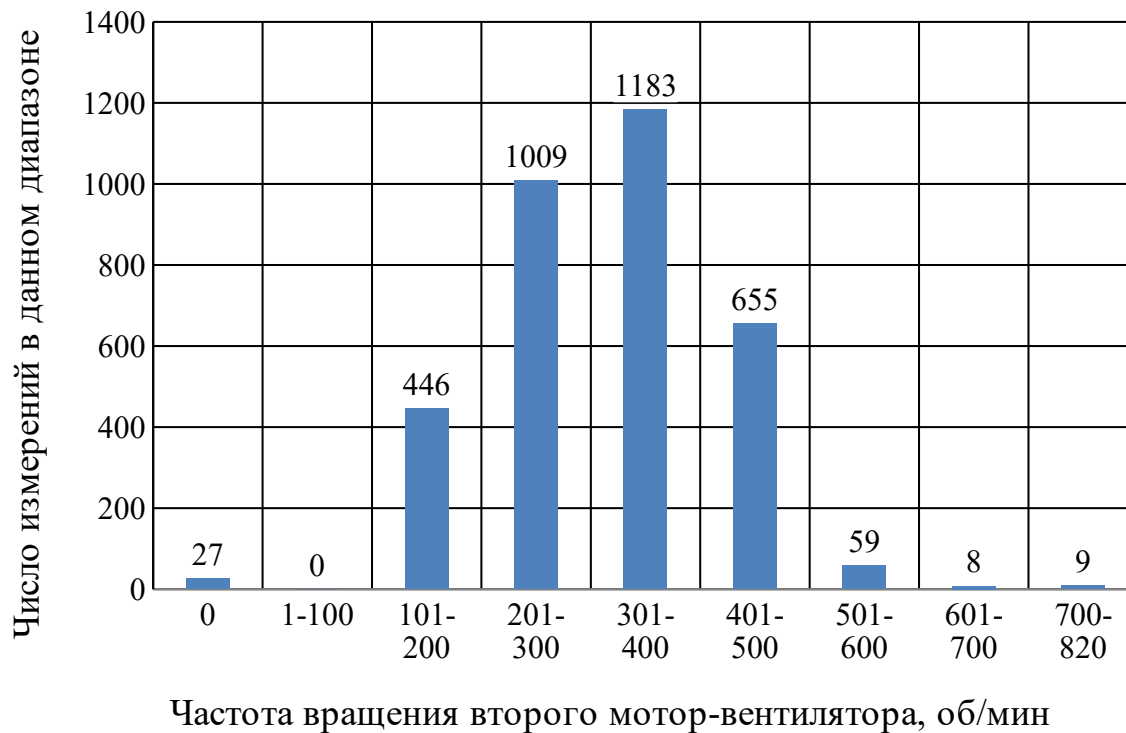
Рис. 5. Группированный статистический ряд частоты вращения второго мотор-вентилятора тепловоза ТЭП70БС № 176 на 13-й позиции контроллера
