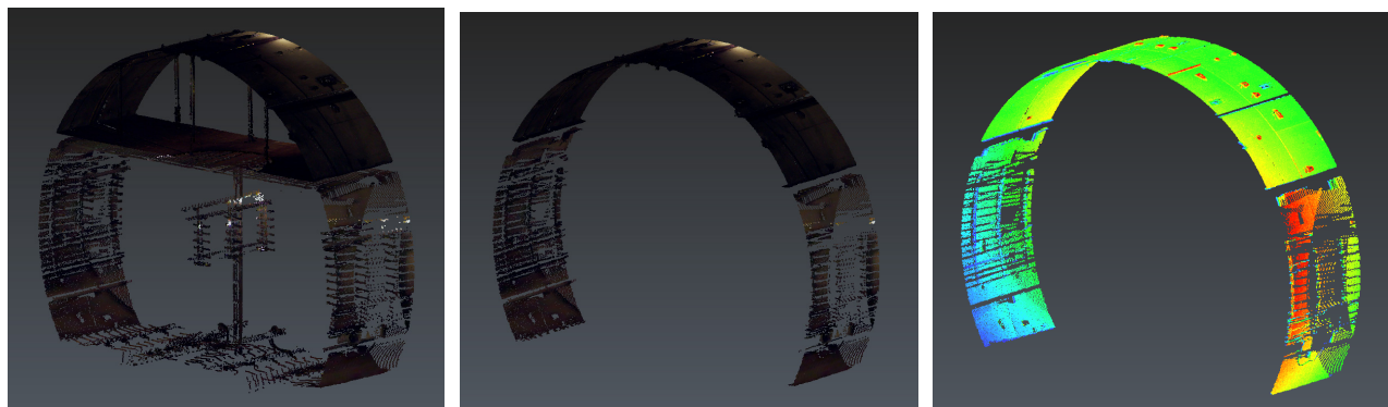
Рис. 7. Результаты чистки и сегментации облака точек (слева направо)
