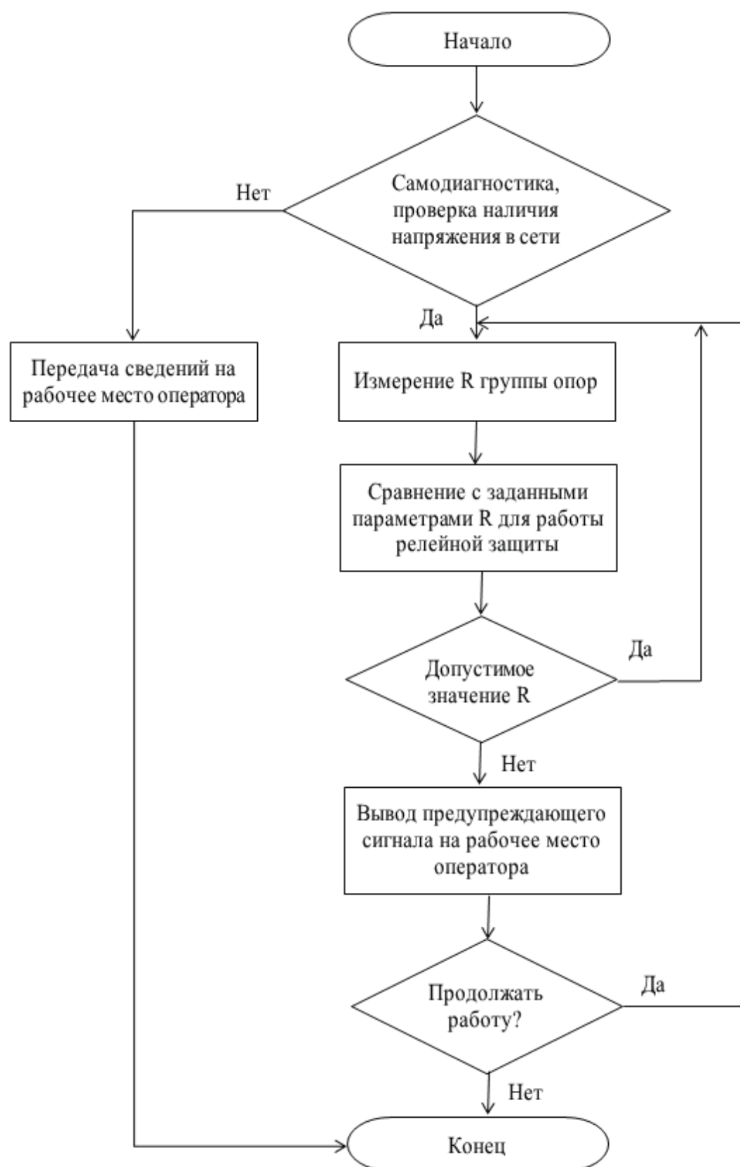
Рис. 3. Блок-схема алгоритма работы устройства
