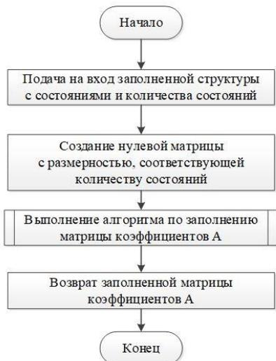
Рис. 3. Блок-схема с описанием шага генерирования списка
