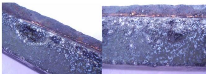
Рис. 2. Зоны расплавления и места сильного пригорания
