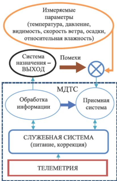
Рис. 2. Модельное отображение МДТС автономной мобильной метеостанции
