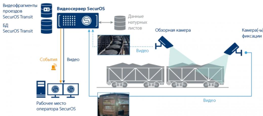
Рис. 2. Архитектура SecurOS Transit
