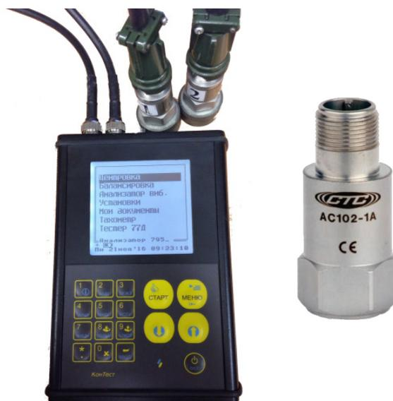
Рис. 2. Виброанализатор
