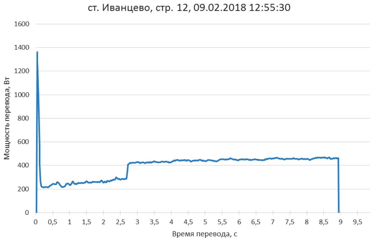
**Рис. 5.** Проявление самопроизвольного движения острияков на графике мощности перевода
