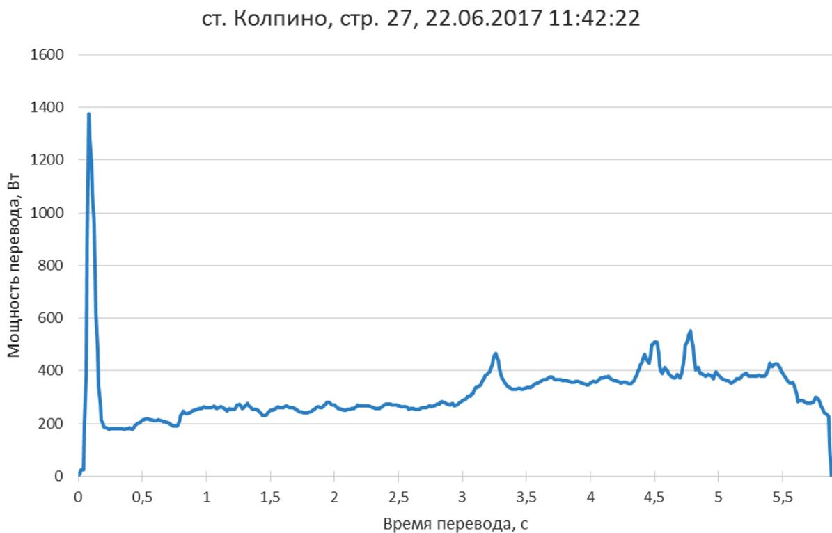
**Рис. 8.** Проявление загрязнений стрелочных башмаков на графике мощности перевода
