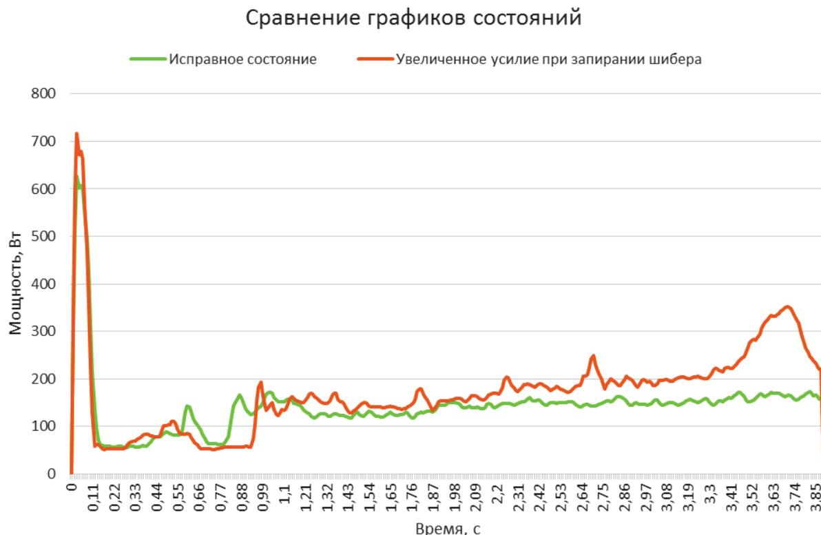
**Рис. 17.** Сравнение графиков мощности перевода исправной стрелки и стрелки с увеличенным усилием заперания шибера
