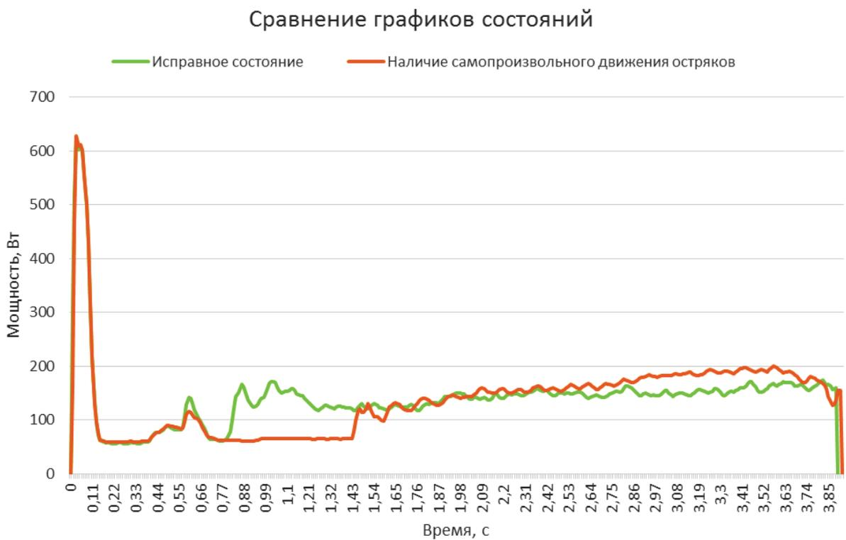
**Рис. 16.** Сравнение графиков мощности перевода исправной стрелки и стрелки с наличием самопроизвольного движения острия
