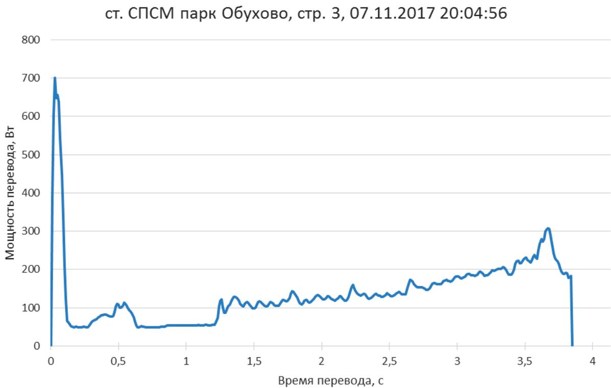
**Рис. 11.** Проявление увеличенного усилия при заперении шибера на графике мощности перевода
