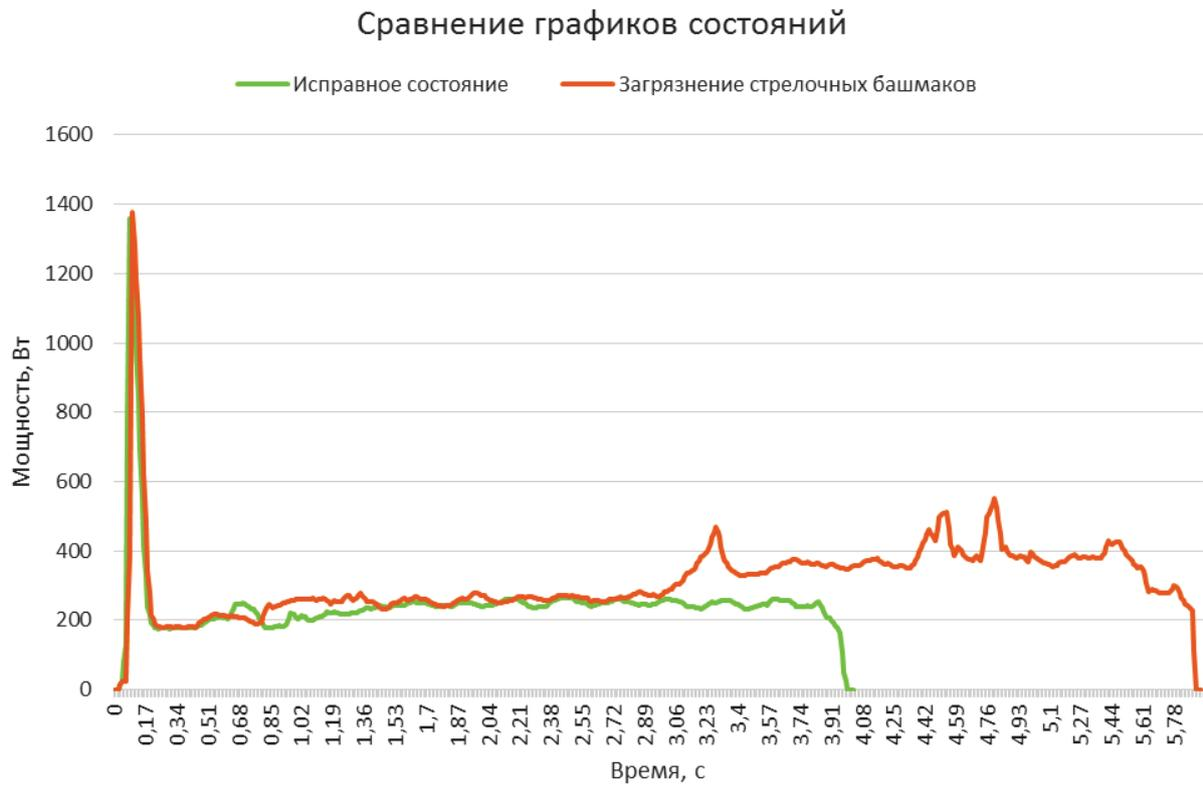
**Рис. 15.** Сравнение графиков мощности перевода исправной стрелки и стрелки с загрязненными стрелочными башмаками
