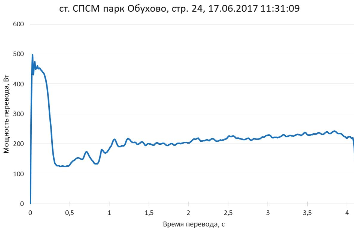
**Рис. 1.** Проявление переходного сопротивления в фазах ЭД на графике мощности перевода
