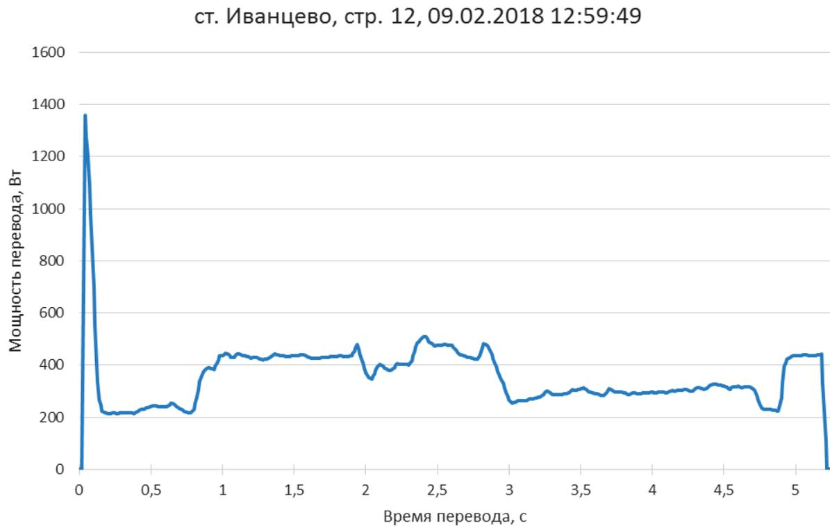
**Рис. 7.** Сравнение графиков мощности перевода исправной стрелки и стрелки, находящейся в неисправном состоянии
