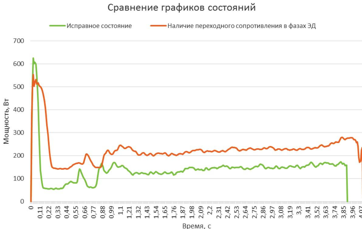
**Рис. 13.** Сравнение графиков мощности перевода исправной стрелки и стрелки, находящейся в неисправном состоянии (наличие переходного сопротивления в фазах ЭД)
