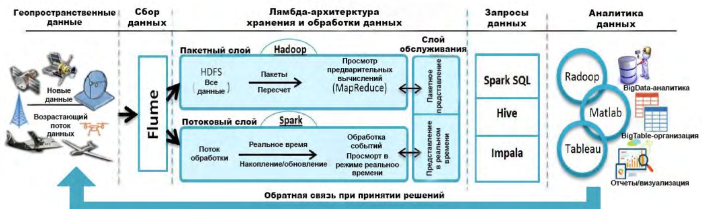
Рис. 2. Лямбда-архитектура для работы с геопро пространственными данными
