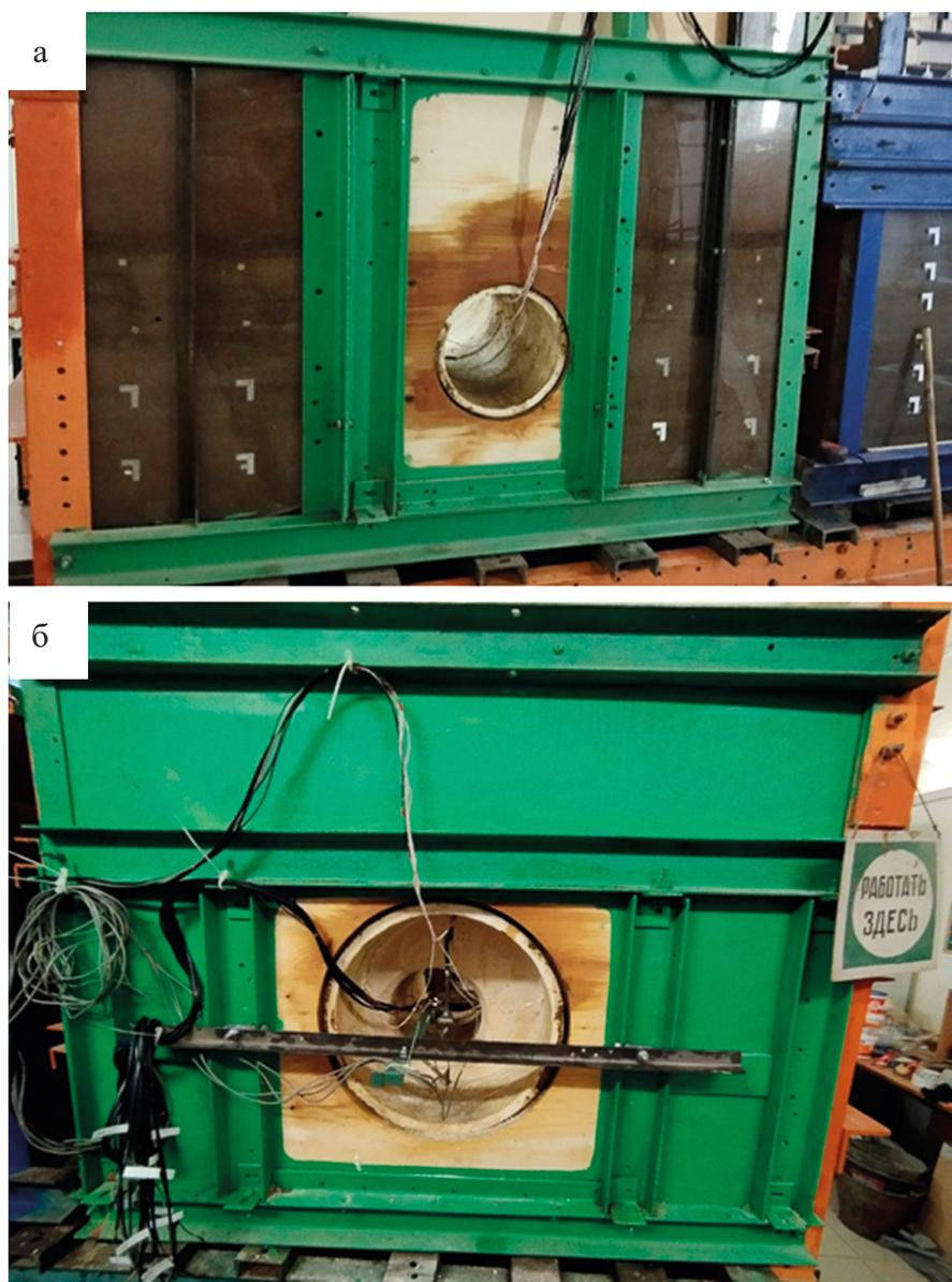
**Рис. 7.** Общий вид физической модели узла сопряжения перегонного и станционного тоннеля:
