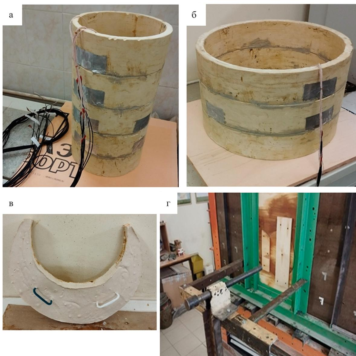
**Рис. 4.** Моделирование обделок перегонного и станционного тоннелей:
