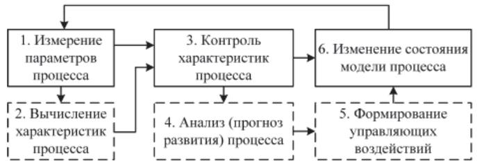
Рис. 5. Схема мониторинга технологического процесса
