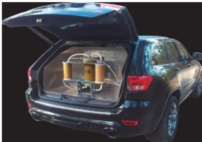
Рис. 3. Генератор мощного ЭМИ в багажнике автомобиля
