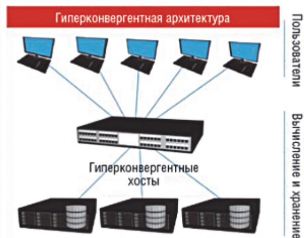
Рис. 5. Архитектура гиперконвергентных систем
