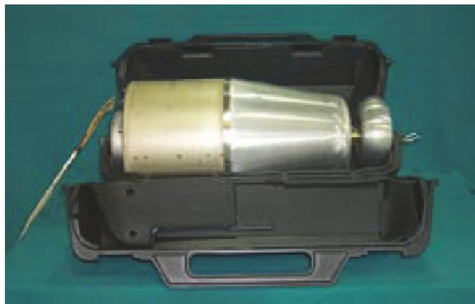
Рис. 1. Малогабаритный источник ЭМИ разового действия
