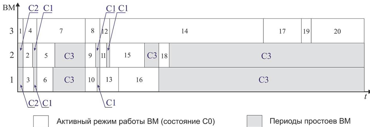
Рис. 2. Временная диаграмма реализации параллельного алгоритма комплекса целевых задач перспективной БВС для трех VM
