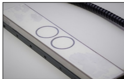
Рис. 3. Принципиальная схема и опытный образец датчика обледенения
