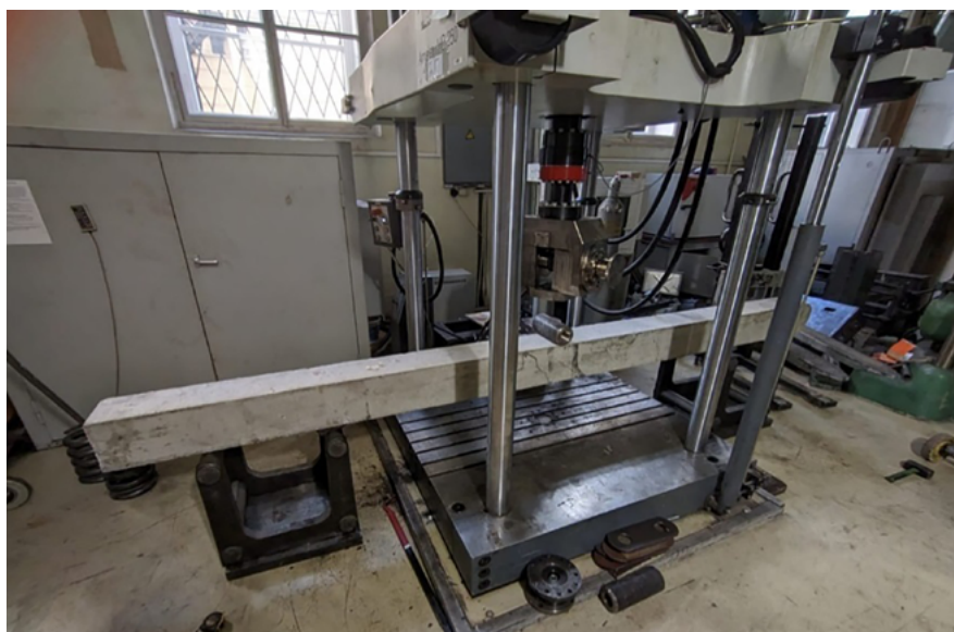
Рис. 9. Стенд для испытаний свай на трехточечный изгиб
