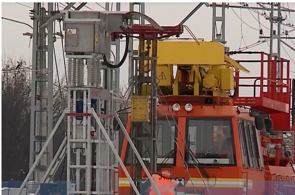
Рис. 4. Устройство «Колибри» наносит антигололедное покрытие [18]
