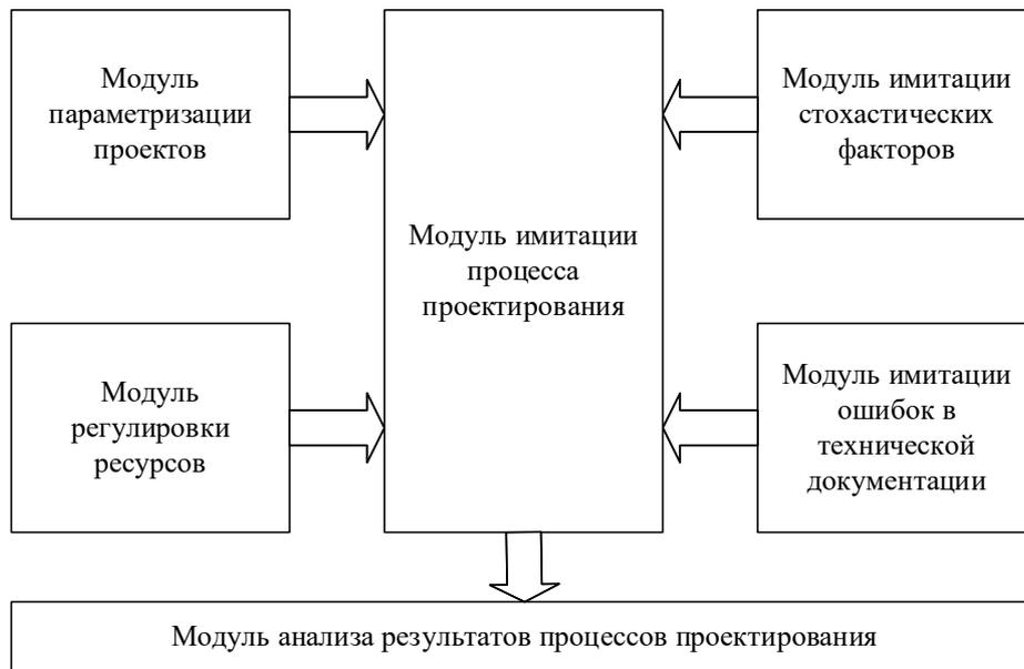
**Рис. 3.** Структурная схема модели процессов проектирования СЖАТ
