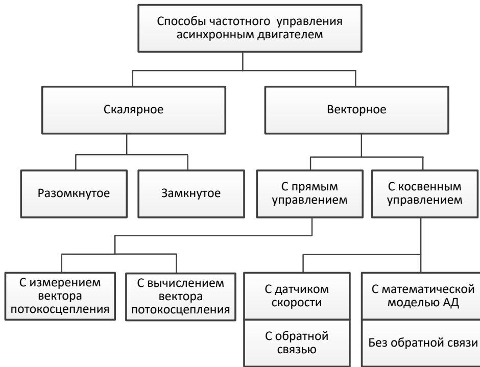
Рис. 1. Способы частотного управления асинхронным двигателем
