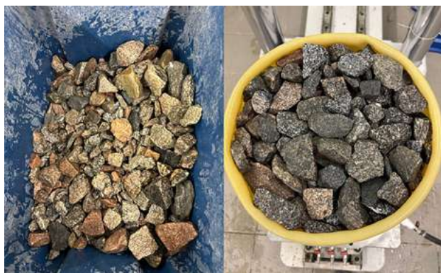
Рис. 3. Сборка образца из чистого щебня
