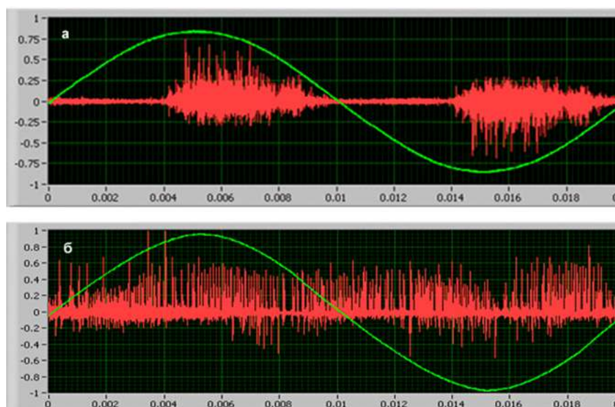
Рис. 4. Осциллограммы регистрации частичного разряда при 5,0 кВ: а — N_i = 0 ; б — N_i = 500
