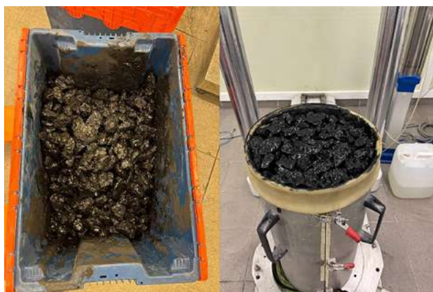
Рис. 4. Сборка образца из загрязненного щебня угольной пылью
