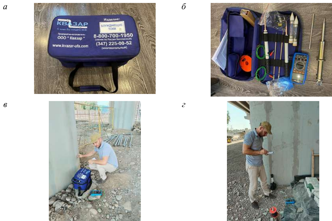
Рис. 4. Натурный поиск и измерения характеристик блуждающего тока (автор: А. А. Белый): а, б — набор «Блуждающие токи»; в, г — процесс натурных измерений
