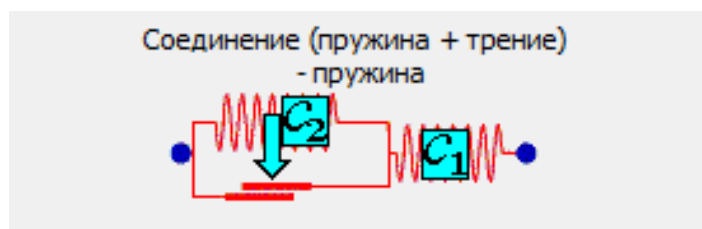
Рис. 4. Схема соединения элементов рессорного подвешивания в программной среде «Универсальный механизм»
