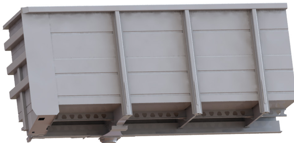
Рис. 12. Внешний вид кузова с оптимизированной поддерживающей балкой
