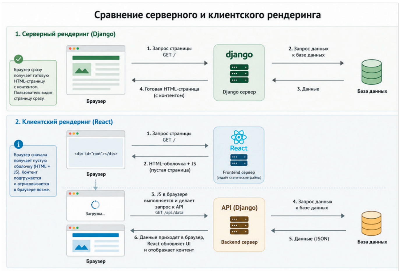
Рис. 1. Схема сравнения серверного рендеринга на Django и клиентского рендеринга на React
