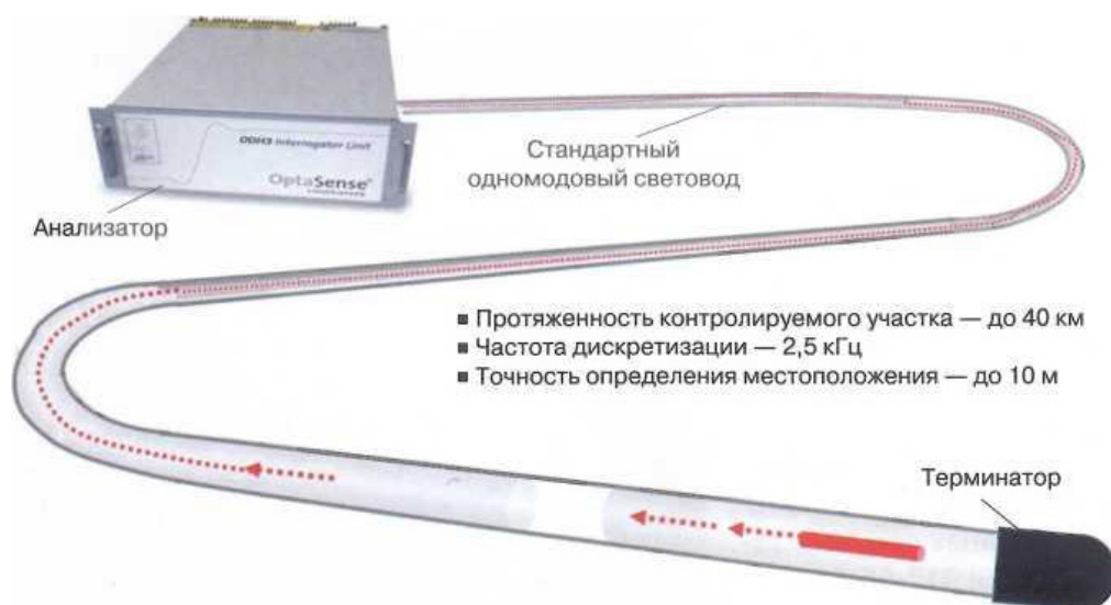
Рис. 5. Технические конструктивы волоконно-оптического кабеля
