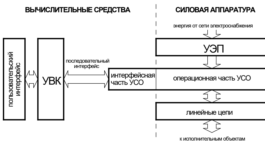
Рис. 1. Многоуровневая структура микропроцессорной системы ЖАТ
